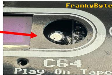
Der Kondensator C1 kann auch liegend eingebaut werden
