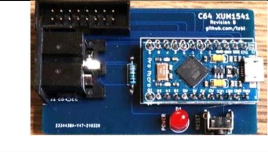
Der Arduino Pro Micro ist fertig mit der aktuellsten Firmware geflasht.
