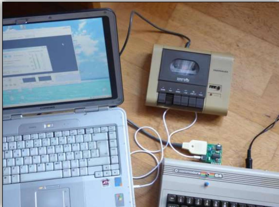
Vergewissern Sie sich, dass der Aufnahmepegel hoch ist. Wenn Sie ihn anpassen müssen, können Sie R8 mit einem kleinen Schraubenzieher drehen. Im Uhrzeigersinn für mehr Leistung.
