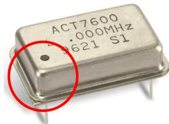
Der Oszillator hat eine Ecke, diese muss links unten sein!
