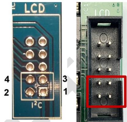
Display-Anschluss der 1541-rebuild version 1.4.2
