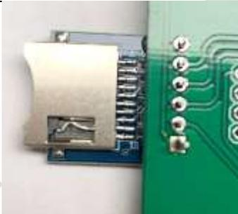
Das Expansion Board genau auf die Platine setzen
